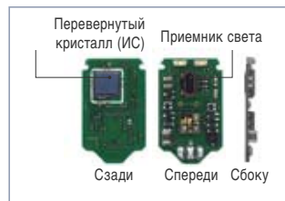
Новая технология монтажа для надежного подавления дальней зоны при толщине корпуса 3,5 мм
