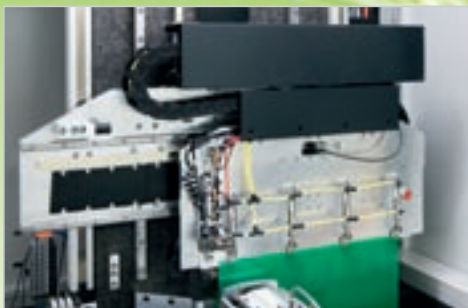
Линейные серводвигатели со стальным сердечником в процессе изготовления печатных плат для высокودинамичного и точного позиционирования инструментов.
