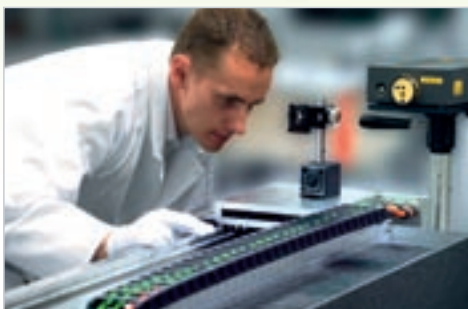
Точные измерения с помощью лазерного интерферометра для обеспечения качества при создании данных для составления карты стадий.
